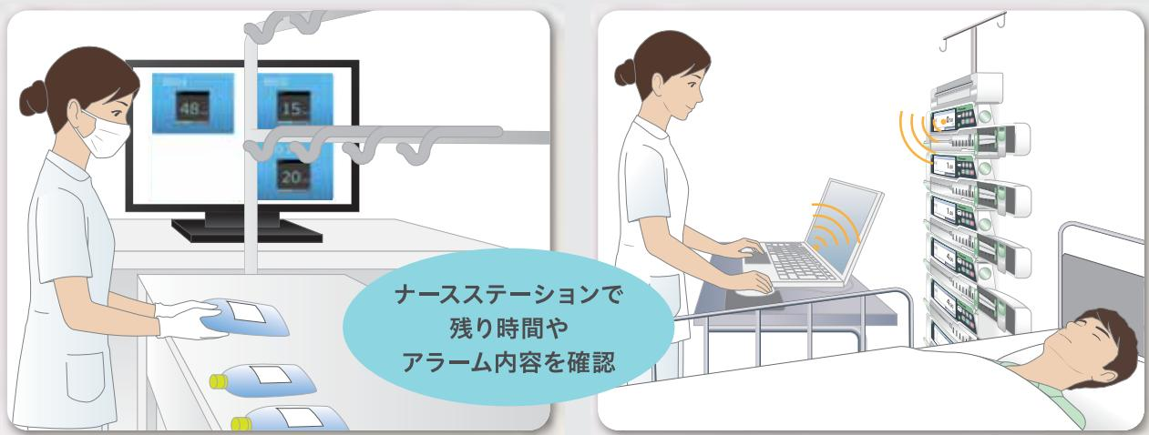
ベッドサイドのモニタと離れた場所にあるセントラルモニタの両方で、スマートポンプの稼働状況をリアルタイム表示。スムーズな薬剤交換や迅速なアラーム対応など、タイムリーで効率的な看護に貢献します。
